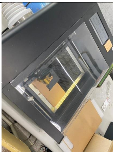
雷射切割製作指示牌
